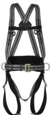
Imbracatura anticaduta con 2 punti di attacco, 1 dorsale, 1 sternale e cintura di posizionamento. Regolazione dei cosciali, sottoglutei. Conforme a EN361 e EN358. DPI di 3ª categoria.
